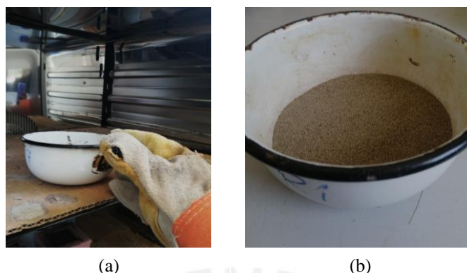
Figura 4.2: Ensayo de contenido de humedad: a) Se colocó aproximadamente 100 gr de suelo SB en estado natural en el horno b) 24 horas después se retiró y peso el suelo SB en estado seco
