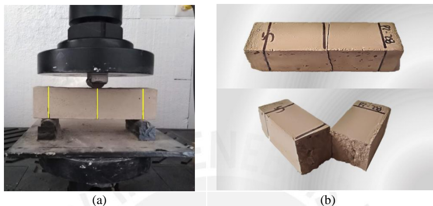
Figura 4.15: Ensayo de flexión en tres puntos: a) Maquina de prueba adaptada y b) el espécimen después del ensayo
