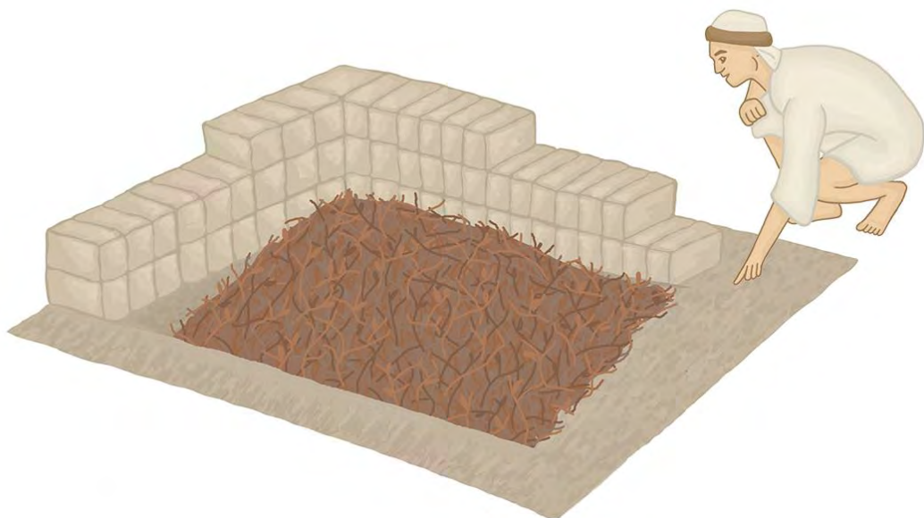
Figura 38. Paso 5: Recubrimiento de carga con material orgánico combustible. (Ilustración: Mayra Fung)
