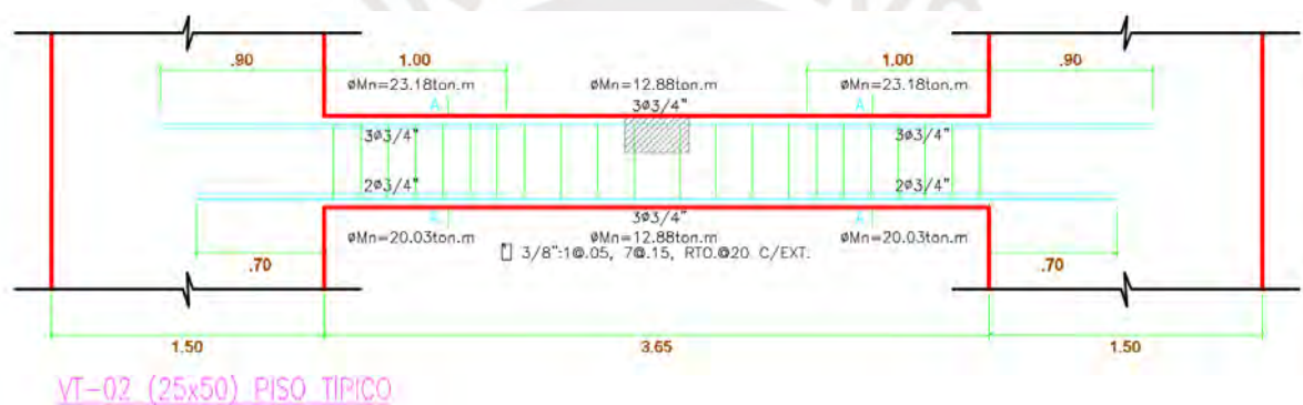
Figura 7.13. Momentos nominales en Viga VT – 02
