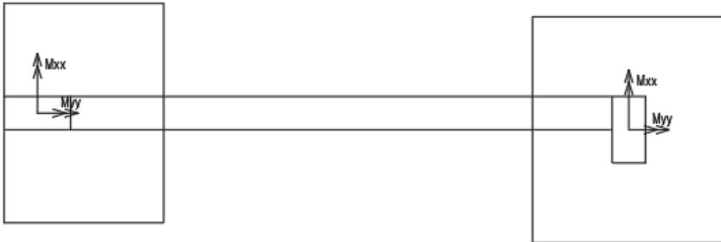
Figura 10.5. Ejes de Referencia para zapata conectada
