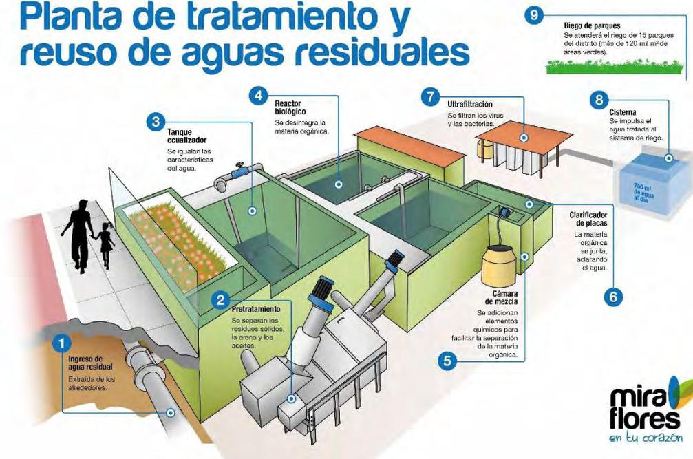
**Figura 11. Planta de tratamiento de aguas residuales**
