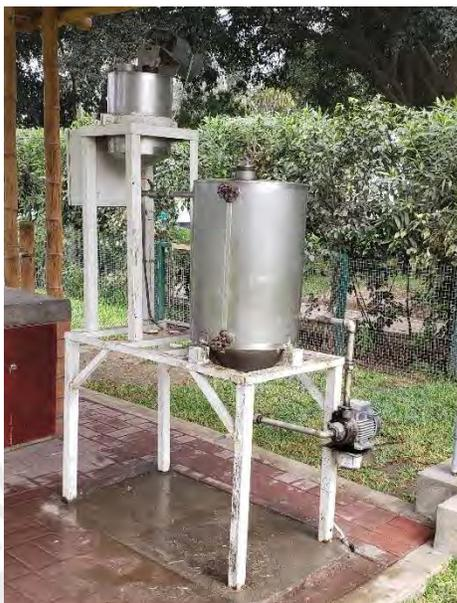
**Figura 14. Reactor para conversión de aceites usados en biodiesel**
