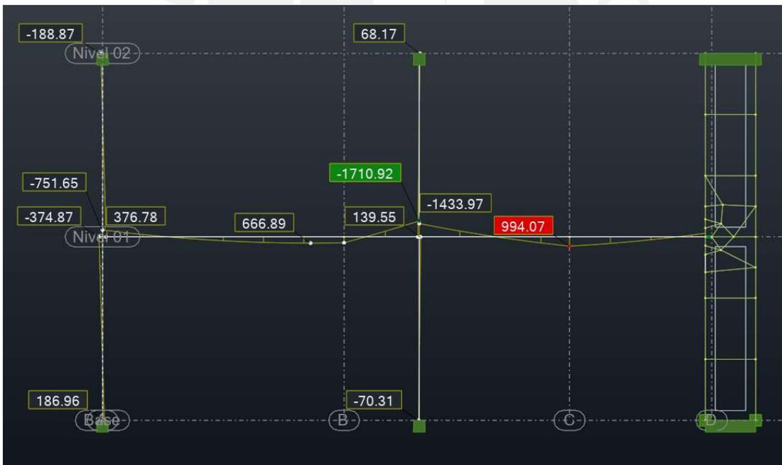
Figura 7-17 Momentos de viga V-03 (carga viva CV) Fuente: Robot Structural Analysis
