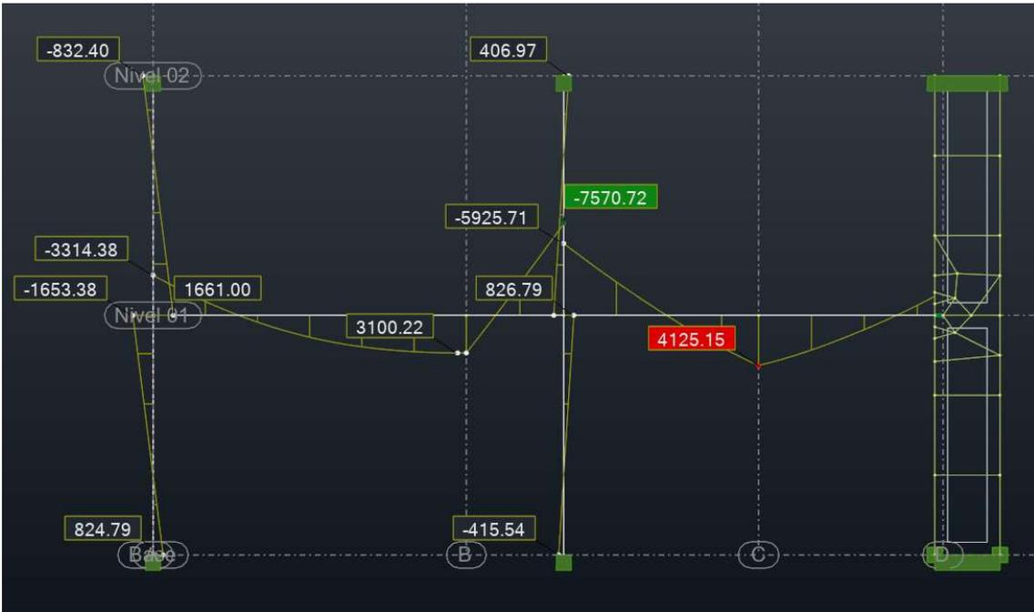
Figura 7-16 Momentos de viga V-03 (carga muerta CM) Fuente: Robot Structural Analysis
