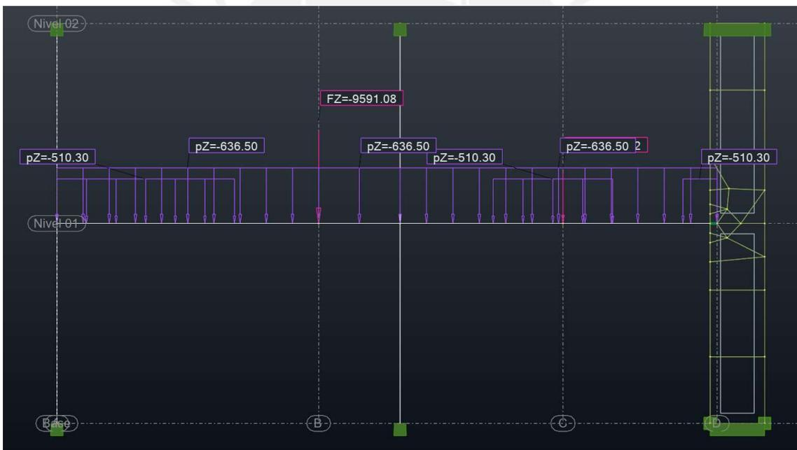
Figura 7-10 Carga muerta en Viga V-03 Fuente: Robot Structural Analysis
