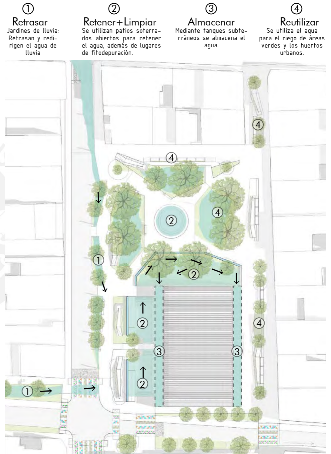
FIGURA 100 Funcionamiento del sistema resiliente
