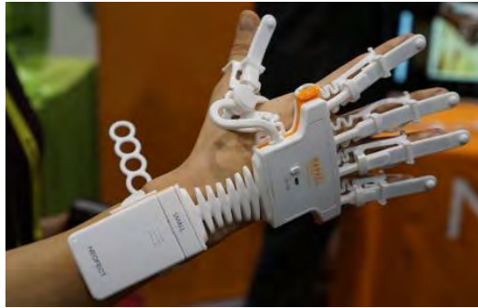
Figura 1.7. Exoesqueleto Rafael Smart Glove.
