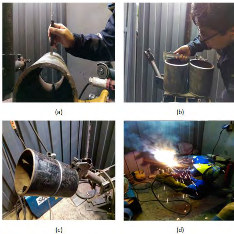
Figura 2-1: (a) Inspección de hi-low. (b) Inspección de material base. (c) Cupón de 45° para calificación. (d) Proceso de soldadura.
