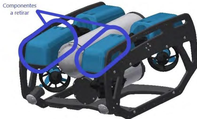
Figura 2.12: Modelo CAD del vehículo BlueROV2. Adaptado de (Blue Robotics Inc, s.f.).
