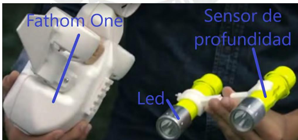
Figura 2.24: Integración del sensor de profundidad del concepto de solución 3. Adaptado de (Fidel, 2016).
