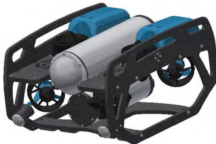
Figura 2.13: Modelo CAD del vehículo BlueROV2 sin dos espumas. Adaptado de (Blue Robotics Inc, s.f.).
