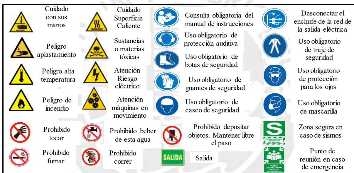
Figura 3.12: Señalética de advertencia, obligación, prohibición y evacuación Fuente: Guillén (2019)
