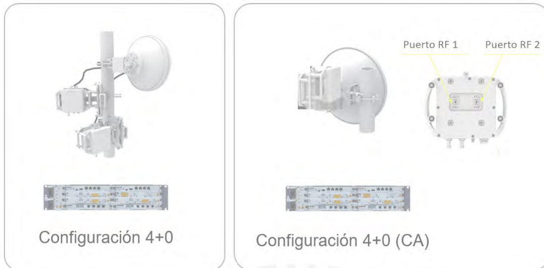
Figura 17: Configuración de enlaces microondas tradicional y con funcionalidad 4+0 XPIC (Fuente: Huawei Technologies CO. Adaptado al español [23]).
