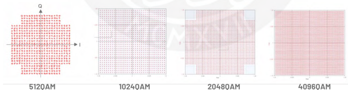
Figura 13: Constelaciones de acuerdo a la modulación configurada en los enlaces microondas (Fuente: Microwave-Link [18]).
