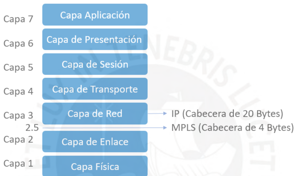
Figura 21: Gráfica del Modelo OSI especificando el nivel de la capa IP y MPLS (Fuente: Elaboración propia).
