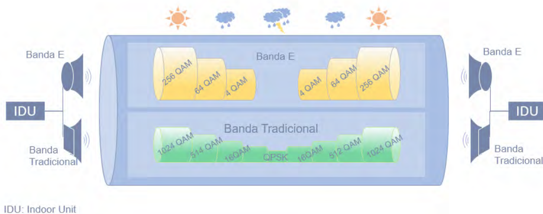
Figura 18: Configuración de dos enlaces en banda tradicional y banda E logrando la configuración Super Dual Band (Fuente: Huawei Technologies Co. Adaptado al español [24]).
