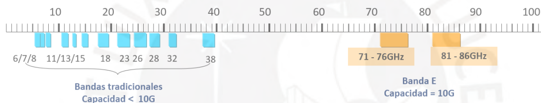
Figura 10: Asignación de bandas tradicionales y nueva banda E (Fuente: Huawei Technologies CO [17])
