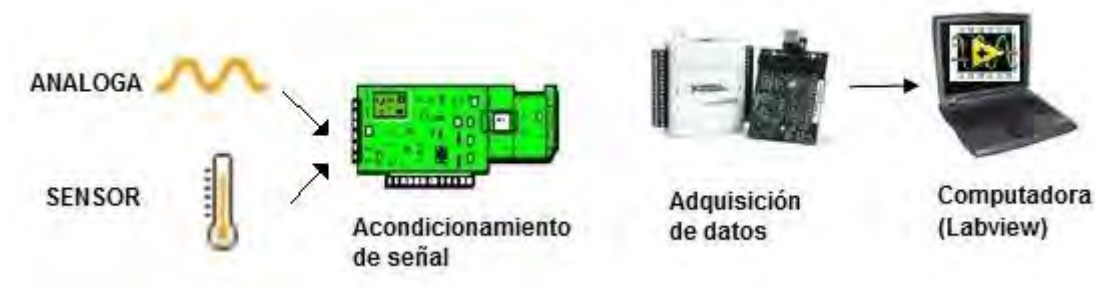
Figura 4. Esquema de la adquisición de datos con Labview.
