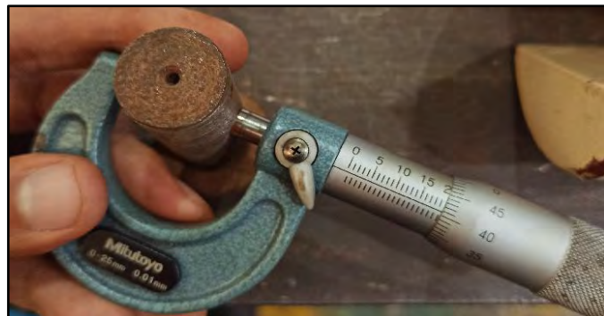
Figura N° 66 Medición con micrómetro del pin.
