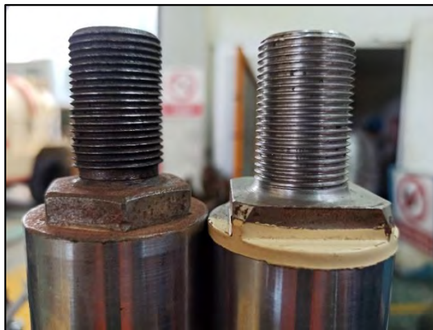
Figura N° 73 Comparacion de acabados entre fabricado (izquierda) y original (derecha).
