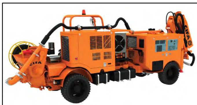
Figura N° 4 Lanzador CIFA CST 8.20. (CIFA S.p.A, 2015, p. 1)
