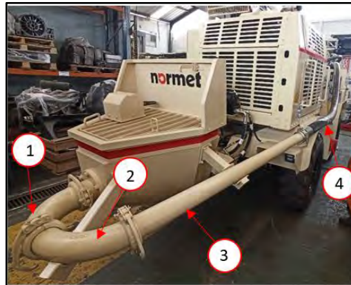
Figura N° 18 Tubos rígidos de salida.
