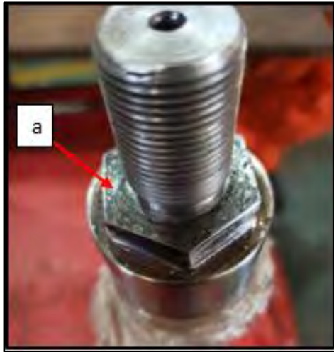
Figura N° 61 Rellenado con soldadura.
