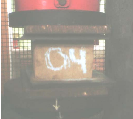
Fig 10: Ensayo Compresión de la Unidad
