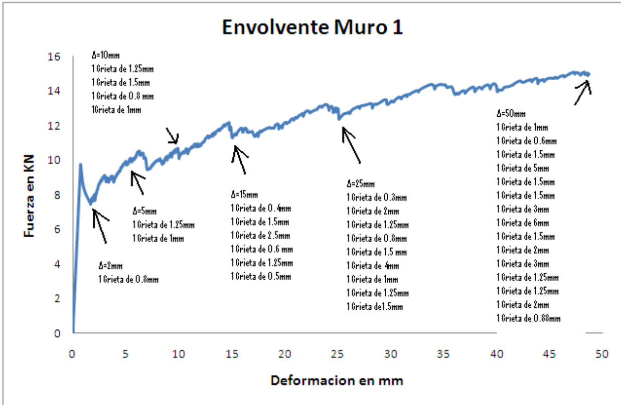
Fig 30: Proceso de Agrietamiento en la envolvente del Muro 1
