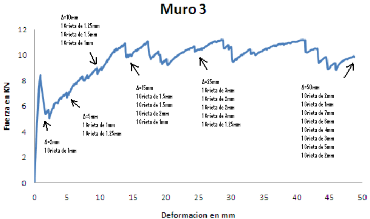
Fig 35: Proceso de Agrietamiento en el Muro 3
