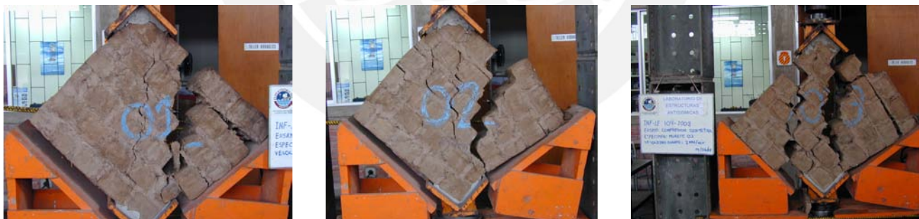
Fig. 14,15y16: Fallas por Tracción Diagonal
