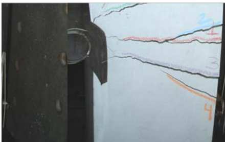
Fig 36: Agrietamiento Máximo del Muro 3
