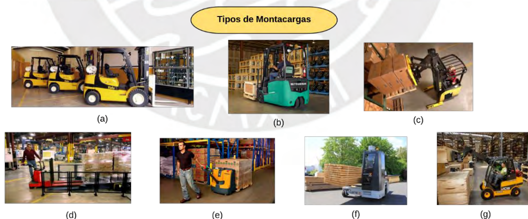
Figura 1.3. Tipos de montacargas: (a) Montacargas contrabalanceado (b) Montacargas de tres ruedas (c) Montacargas apilador (d) Patín hidráulico © Patín eléctrico (f) Montacargas lateral (g) Montacargas telescópico. Fuente: Grúas y Aparejos (2019)
