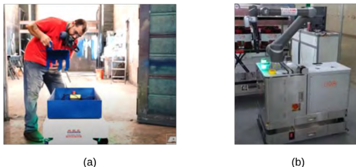
Figura 1.5. Robots AMR para Picking: (a) Ejemplo de Robot AMR de hombre a producto (b) Ejemplo de Robot AMR de producto a hombre. Fuente: ARC Specialties (2019), Guo (2019)
