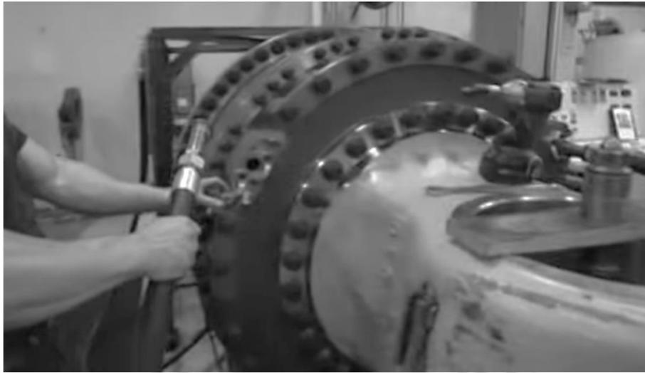
*Fig 2-14 Instalación de líneas hidráulicas durante prueba en el banco
