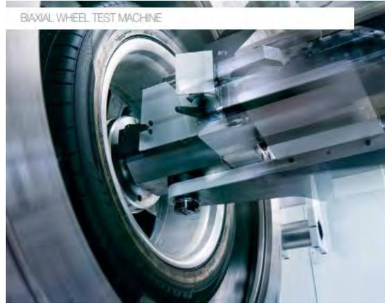
*Fig 2-11 Biaxial Wheel test machine: Modelo ZWARP, marca MAKRA
