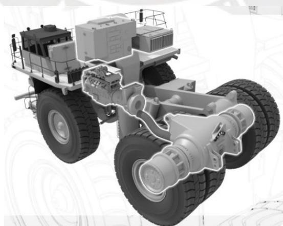
*Fig 2-1 2 Diagrama descriptivo del sistema de potencia e impulso del camión minero
