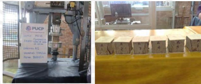
Figura 5.4 – Ensayo de compresión de cubos (Valle, 2019)
