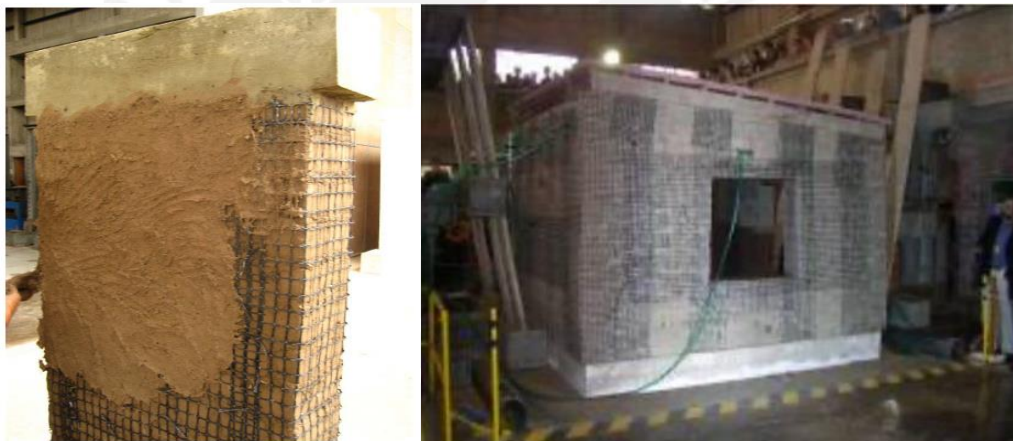
a) Detalle de refuerzo b) Módulo reforzado con geomalla ( D_0=0.13\text{m} )
