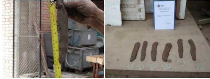
Figura 5.1 – Prueba de cinta de barro (Valle, 2019)
