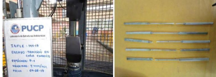
Figura 5.10 – Ensayo de tracción de caña carrizo (Valle, 2019)
