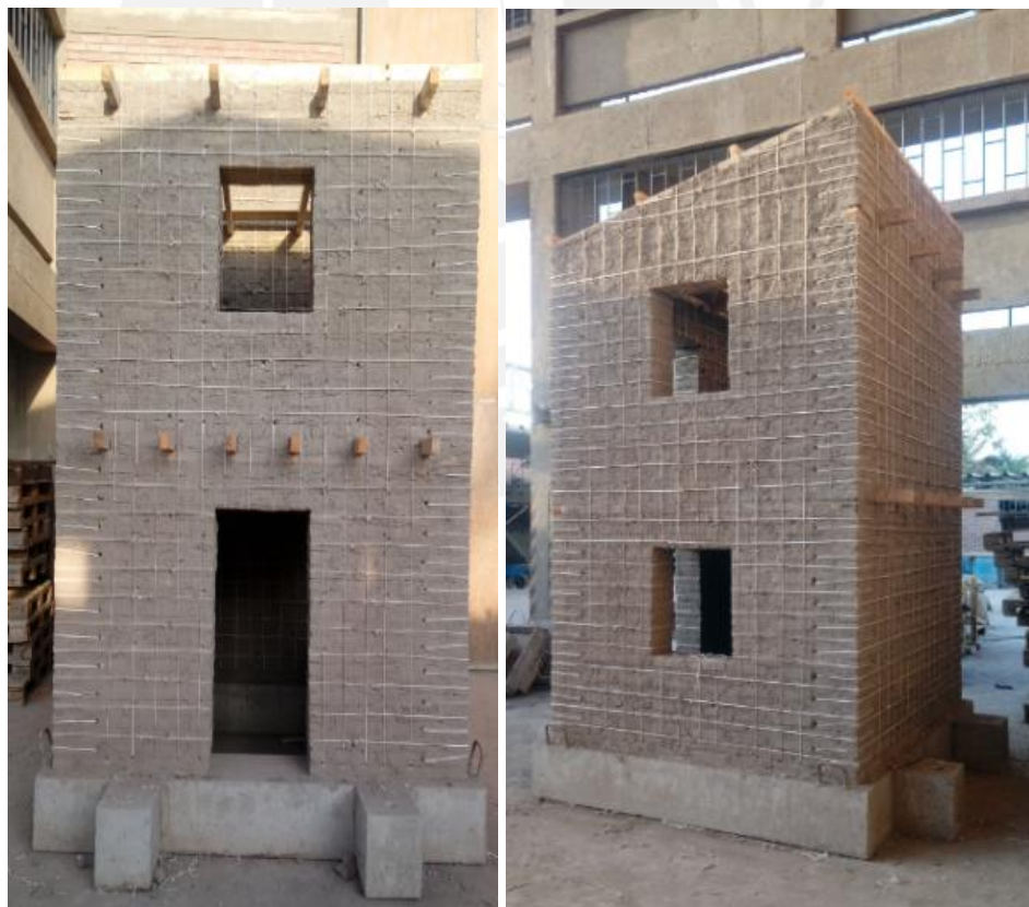
Figura 5.25 - Módulo de adobe reforzado
