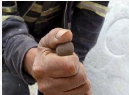
Figura 5.2 – Prueba de cinta de la bolita (Valle, 2019)
