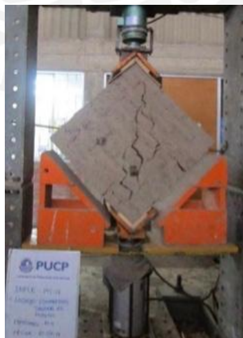
Figura 5.7 – Ensayo de compresión diagonal en muretes (Valle, 2019)
