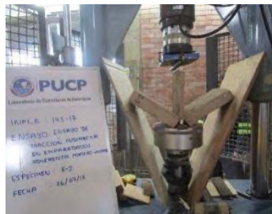
Figura 5.5 – Ensayo de tracción indirecta en emparedados (Valle, 2019)
