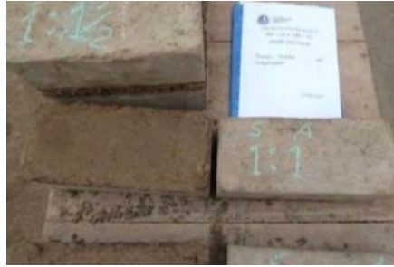
Figura 5.3 – Prueba de emparedado (Valle, 2019)
