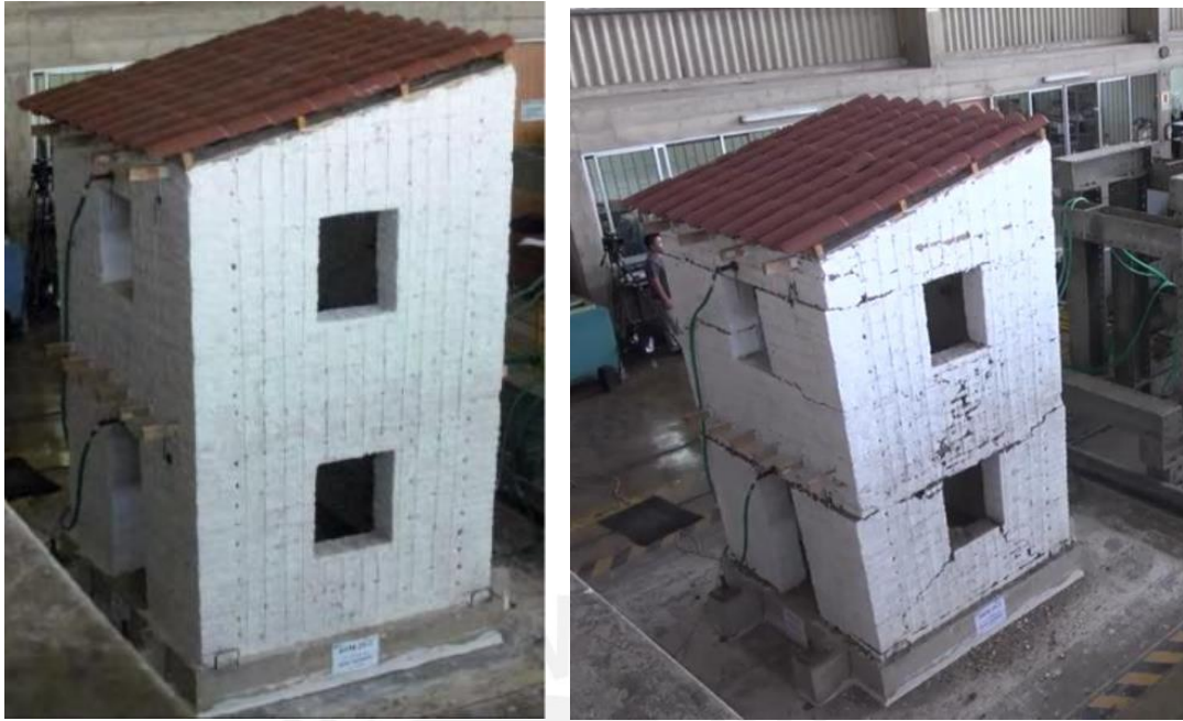
a) Segundo módulo con refuerzo previo al ensayo b) Segundo módulo con refuerzo luego del ensayo (D=60mm).
