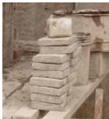
Figura 5.12 - Adobes utilizados en la construcción del modelo
