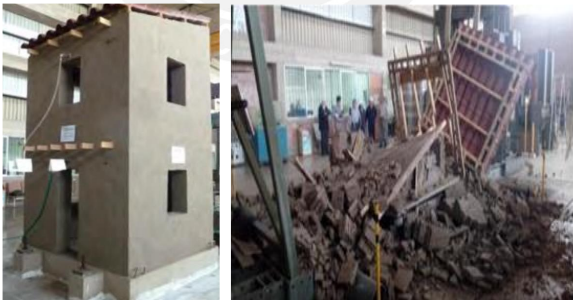
a) Módulo sin refuerzo previo al ensayo b) Módulo sin refuerzo luego del ensayo (D=90mm).
