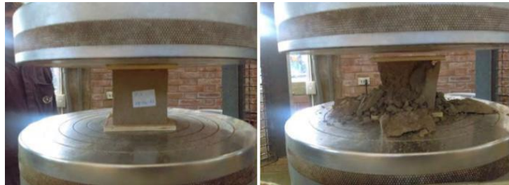
Figura 5.8 – Ensayo de compresión en probetas cúbicas de mortero (Valle, 2019)
