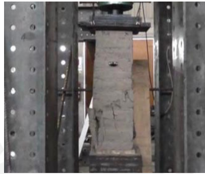
Figura 5.6 – Ensayo de compresión axial en pilas de adobe (Valle, 2019)
