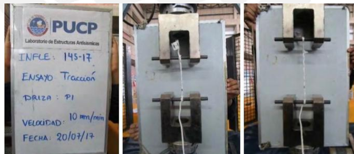
Figura 5.9 – Ensayo de tracción de drizas (Valle, 2019)
