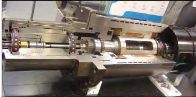
Figura 14: Husillo con un motor integrado entre sus rodamientos.
