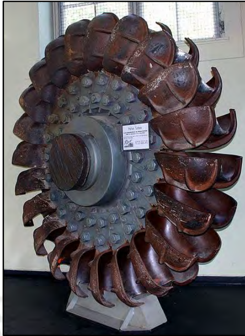
Figura 3: Rotor de turbina Pelton con álabes empernados
