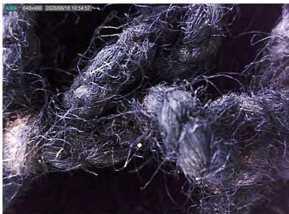
Figura 33: Fotografía de fibra de algodón teñida en azul a partir de Dinolite.
