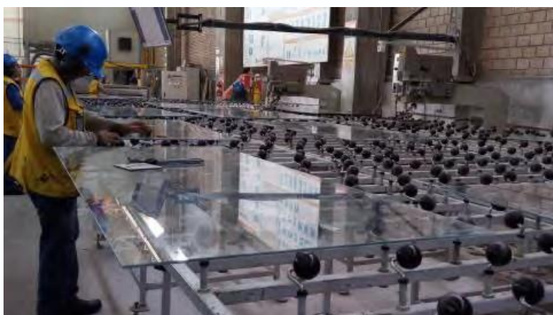
Figura 6: Proceso de entalle. Fuente: Vidrios Arequipa S.A.C.
