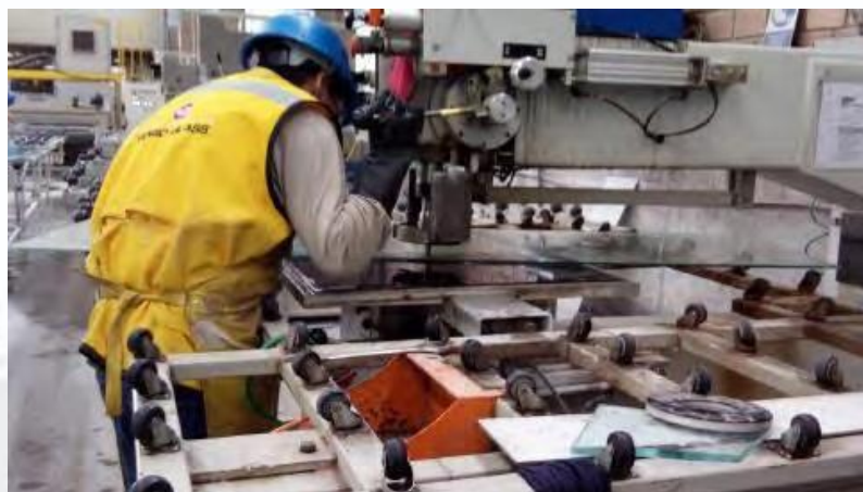
Figura 7: Proceso de perforado. Fuente: Vidrios Arequipa S.A.C.
