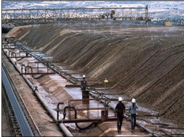
Figura 1: Lixiviación en pilas en Ortiz Gold mine [3]
