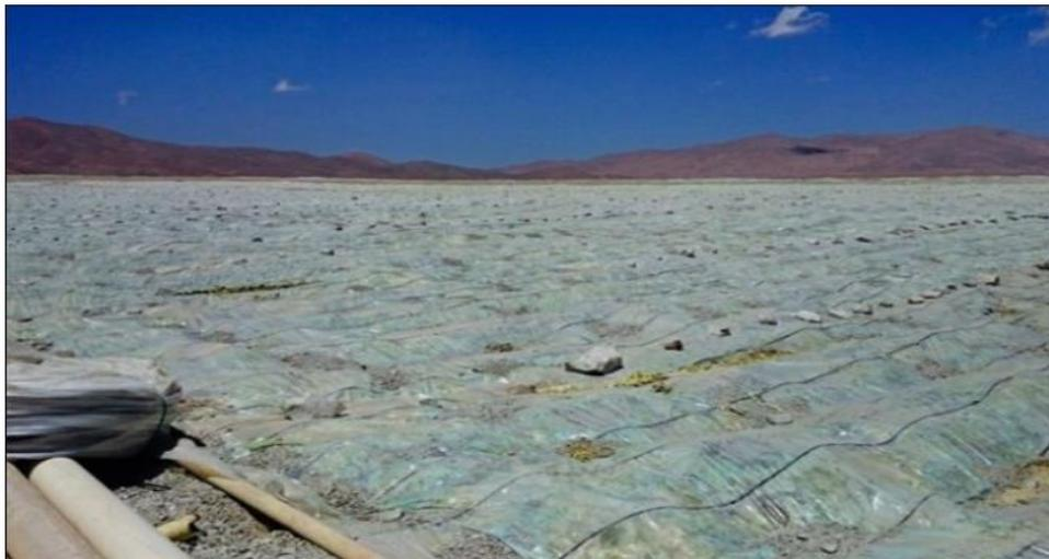
Figura 2: Arreglo de tuberías sobre una pila [10]
