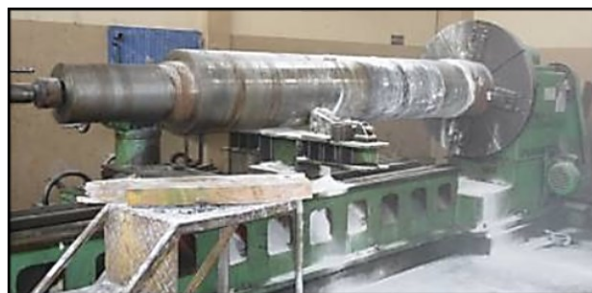
Figura 2 Eje de transmisión de potencia para la turbina de un ingenio azucarero
