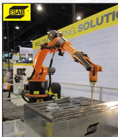
Figura 11 Robot KUKA con implementación ESAB para soldadura automatizada
