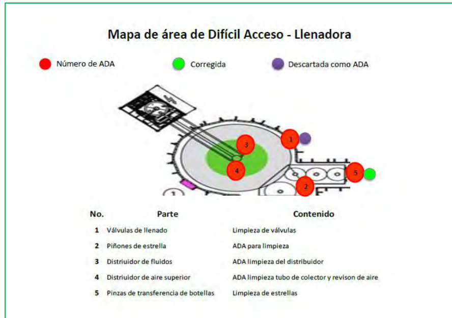
Figura 28: Mapa de Áreas de Difícil Acceso de la Llenadora Fuente: Operación Autónoma LLEN6401 N1 (2020)
