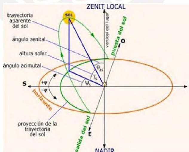
Figura 12: Movimiento del sol, ángulo acimutal y altura solar [32].
