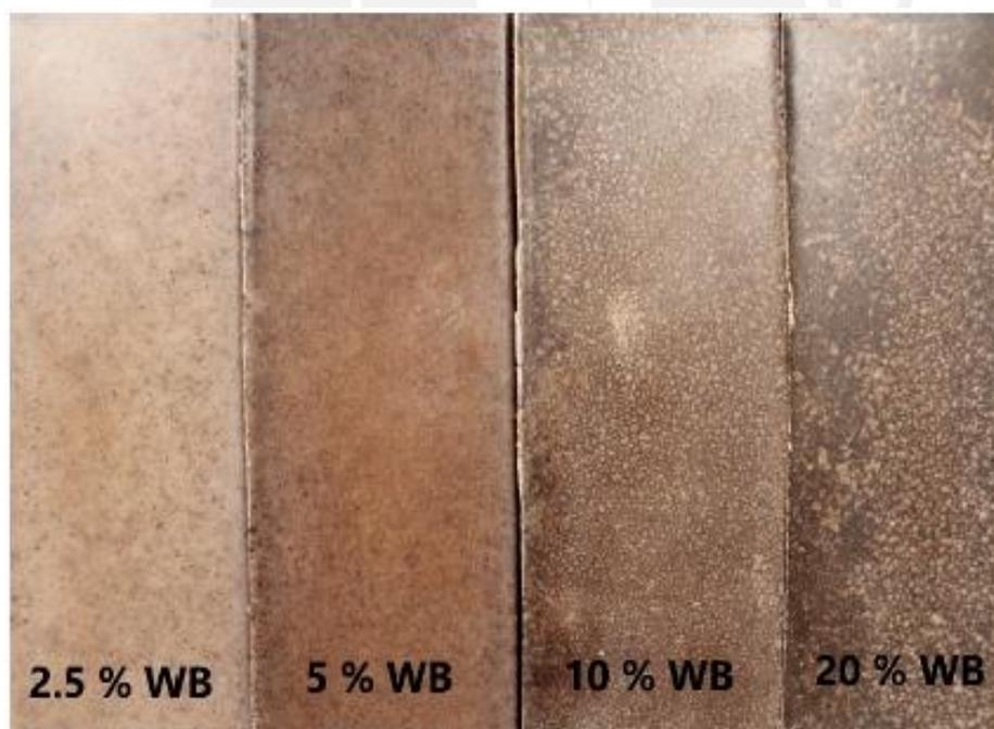
Figura 28 Muestras fabricadas con refuerzo de salvado de trigo
