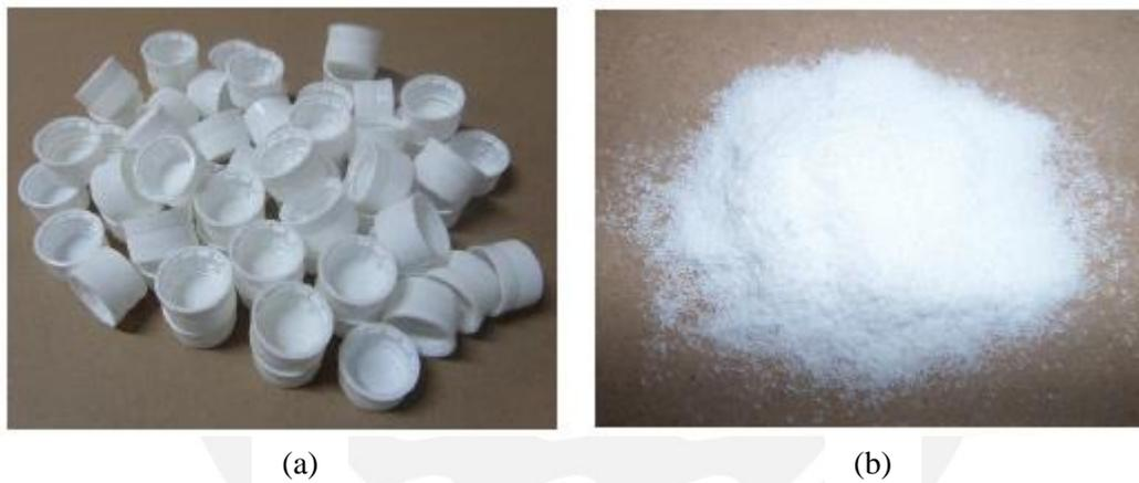
Figura 14 (a) tapas de HDPE recuperado y (b) HDPE pulverizado
