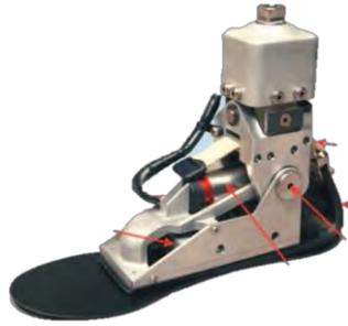
Figura 2.9. Prótesis de pie-tobillo motorizada con elasticidad en serie y en paralelo
