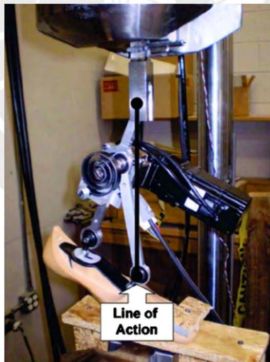
Figura 2.3. Montaje inicial para ensayo de funcionalidad en máquina MTS
