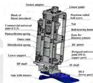
Figura 2.6. Modelo CAD de prótesis de Salazar
