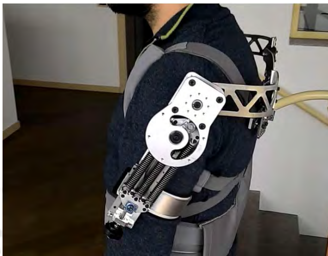
Fig. 3.17 Mecanismo de actuación del exoesqueleto Mate [Giovacchini,2018]
