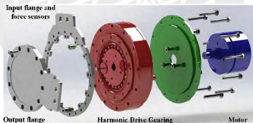
Fig. 1.3 Transmisión electromecánica de cada articulación [Ebrahimi,2017]
