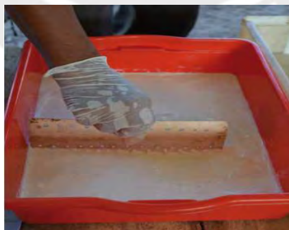
Figura 1.6: Proceso de coagulado del látex.
