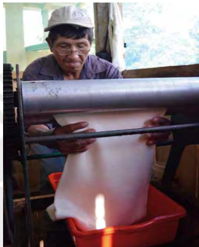
Figura 1.7: Proceso de laminado del látex.
