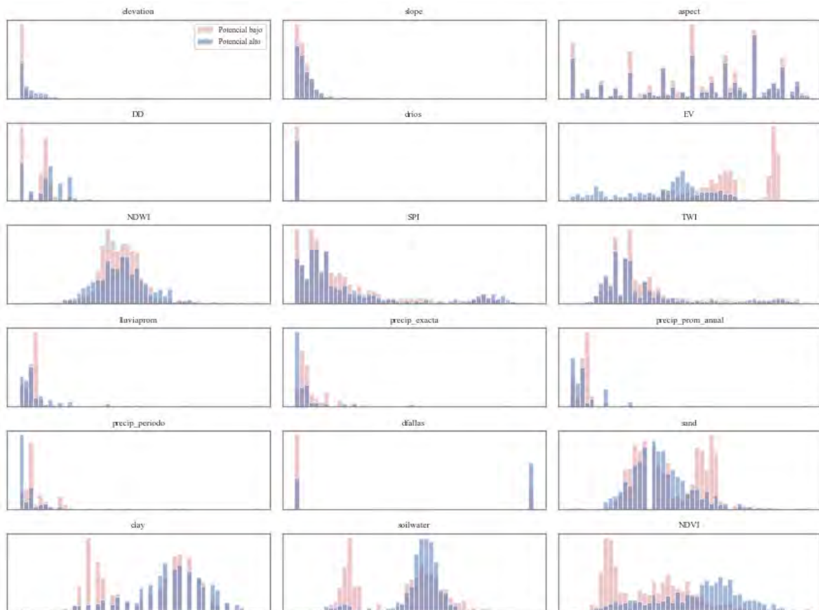
Figura 5.4. Histogramas separados de acuerdo con el potencial de agua subterránea para las variables independientes numéricas.
