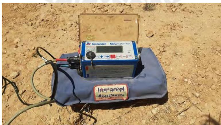
*Figura 8.* “Sismógrafo InstanTel Minimate Plus 4CH”. Fotografía tomada durante una voladura en el lugar de monitoreo preestablecido.
