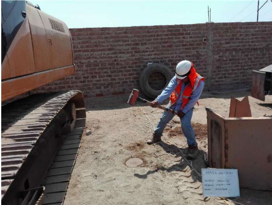
Fotografía 03: Ejecución del shot 01 para el sondaje MASW-01, la comba de 20 lb impacta sobre el plato metálico para generar la onda sísmica.
