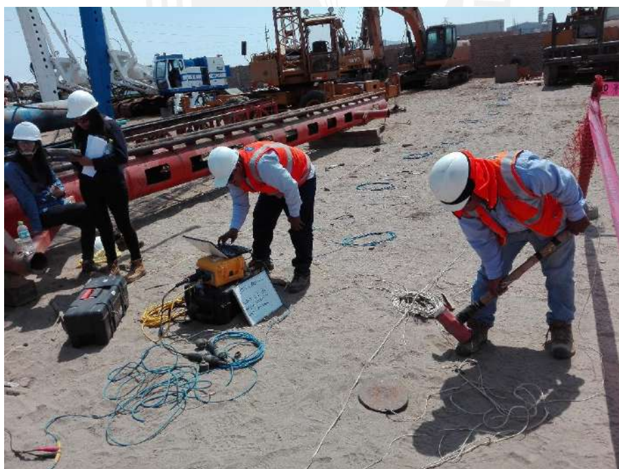
Fotografía 02: Momento realizando el impacto de la comba sobre el plato metálico correspondiente al Shot 01 del sondaje LS-01, empleado para la generación de ondas sísmicas.
