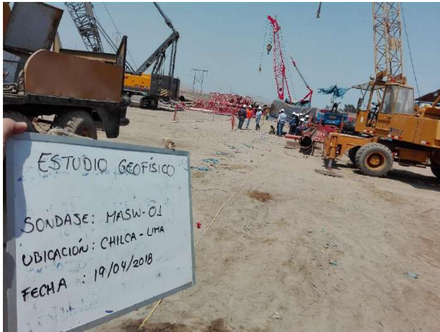
Fotografía 01: Vista panorámica de la zona de trabajo donde se realizó el ensayo sísmico MASW-01. Se observa el personal realizando los shots correspondientes.
