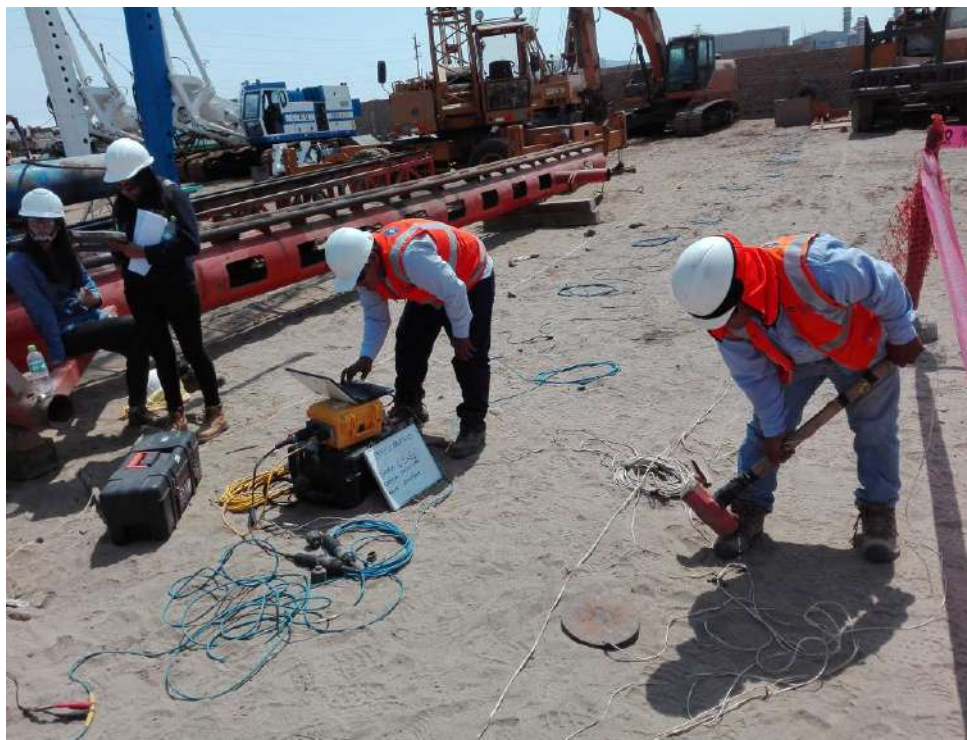
Figura 2.8. Generación de la energía sísmica para el ensayo MASW.
