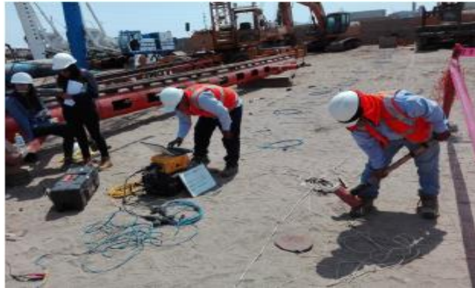
Figura 3.6: Generación de la energía sísmica para el ensayo MASW
