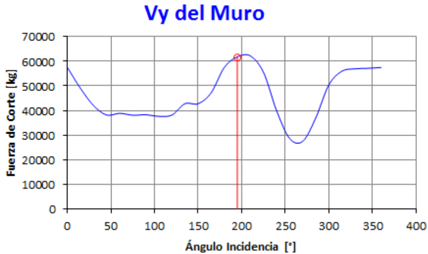
Figura 4.15: Fuerza cortante Vy del modelo 1111 (Sistema de coordenada rectangular)
