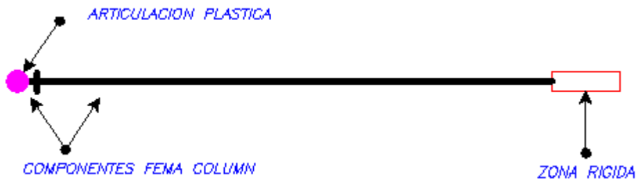
Figura 3.23: Modelo para las columnas en la herramienta de análisis inelástico
