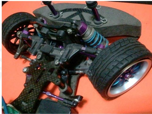
Figura 3-8: Mecanismo de dirección movido por el servomotor
