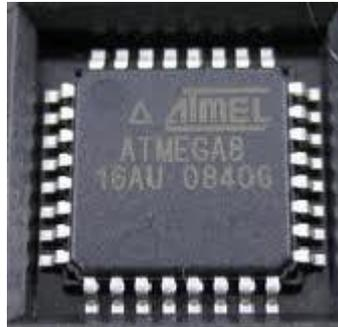
Figura 3-17: Microcontrolador ATMEGA8 16AU
