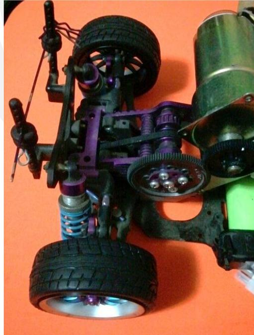
Figura 3-6: Detalle de la transmisión mecánica en las ruedas de tracción
