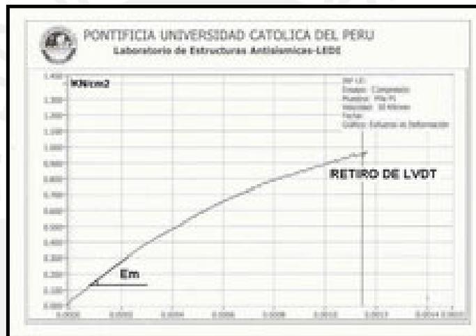
Figura 5.1 - Gráfico  $f_m$ - $\varepsilon$  para una de las pilas ensayadas.
