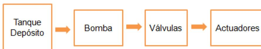
**Figura 2.7.** Diagrama del sistema hidráulico
