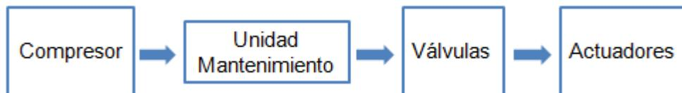
**Figura 2.6.** Diagrama del sistema neumático
