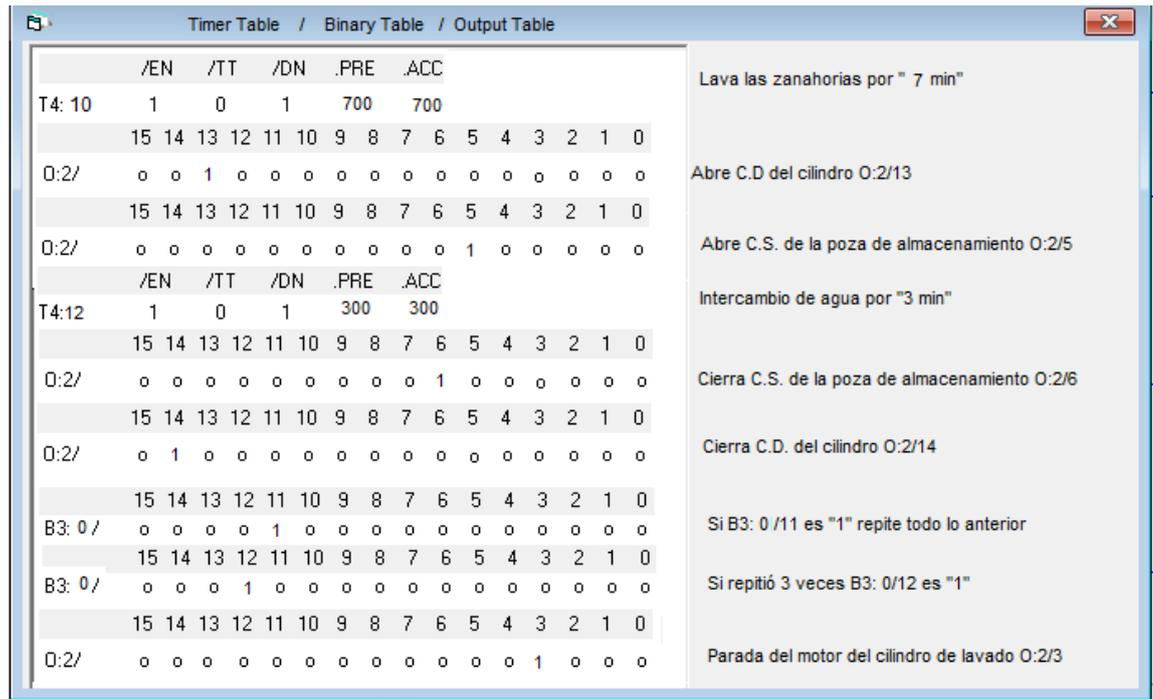
Figura 4.7. Simulación del Proceso de Lavado
