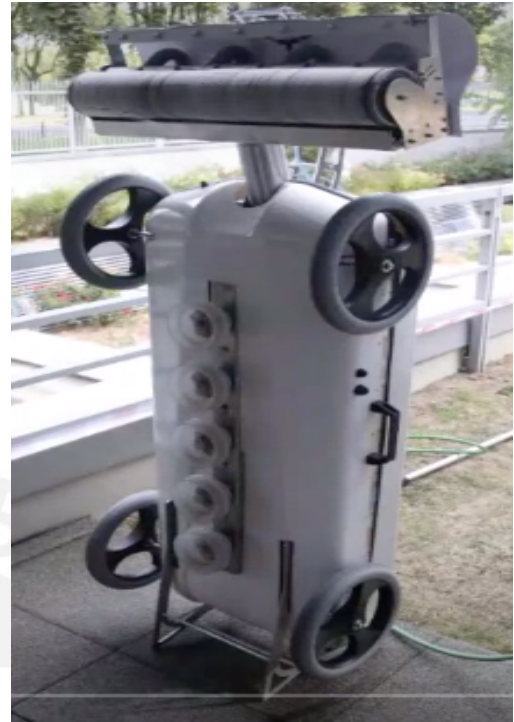
Figura 3. Robot Clean Kong A. En operación; B. Rodillo y sistema de ventosas
