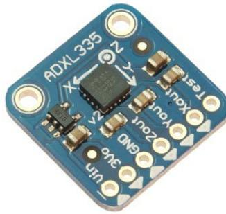
Figura 1.19 Módulo Acelerómetro ADXL335.
