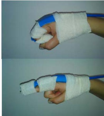
Figura 1.14 Diseño de un dispositivo neumático para rehabilitación de mano mediante funda termo retráctil.
