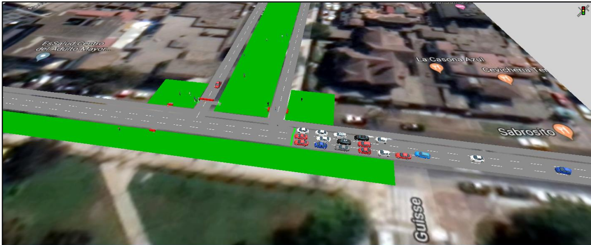
Figura 78. Intersección rediseñada en Vissim
