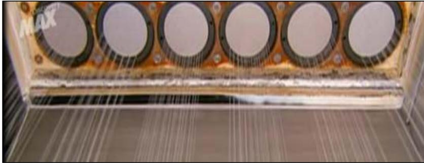
Figura 42: Hilera del extrusor
