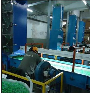
Figura 40: Cinta de inspección de escamas PET
