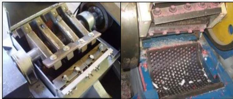
Figura 37: Interior y Criba del Molino
