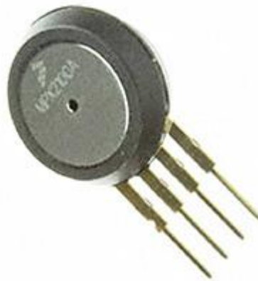
Figura 1.21 Sensor de presión piezorresistivo con diafragma de silicio
