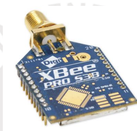
Figura 3-7: Radio XBee-PRO 900HP del fabricante Digi
