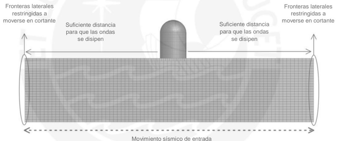
Figura 2.27. Modelo de elementos finitos para el sistema suelo estructura de una planta nuclear (Bolisetti et al., 2018)
