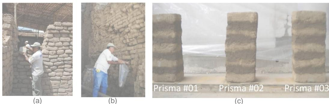
Figura 3.7. Extracción de (a) bloques de adobe y (b) mortero para su caracterización mecánica y (c) prismas construidos para ensayos de compresión (Ramírez et al., 2015)
