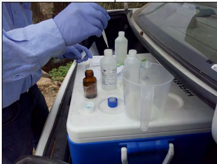
Foto N°10: Preservación de muestras para determinación de Fósforo total.
