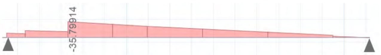
Figura 71. Envolvente de momentos flectores (tn.m) de la viga VC-02 Obtenido del programa SAFE.
