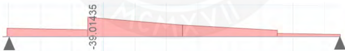
Figura 70. Envolvente de momentos flectores (tn.m) de la viga VC-01 Obtenido del programa SAFE.
