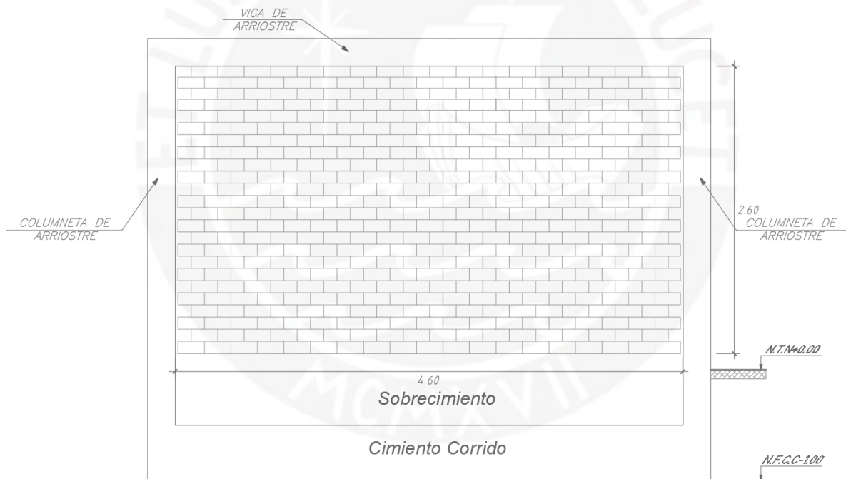
Figura 84. Muro cerco de albañilería a analizar
