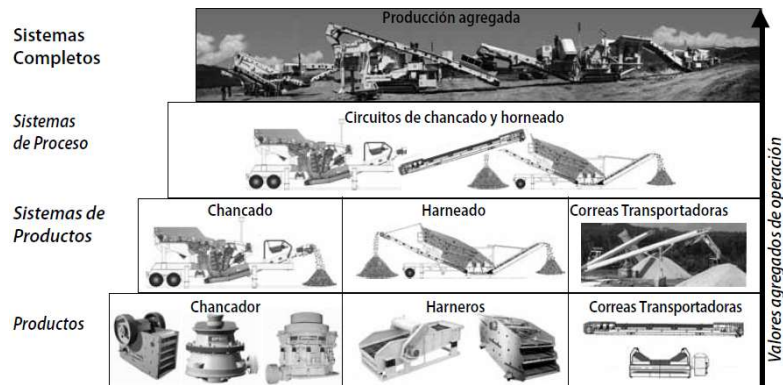
Fig 11. Nivel de sistemas en procesamiento de rocas. Fuente: (METSO, 2004).
