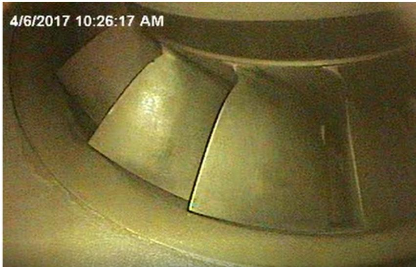
*Figura 19.* Imagen del Álabes de un Motor PT6A Obtenida con un Videscopio
