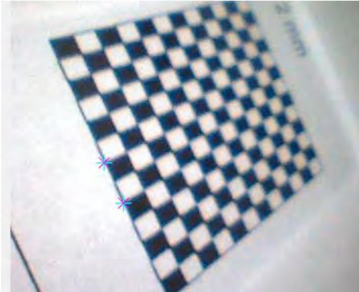
Figura 46. Medición de la Distancia Entre Dos Cuadrículas con un Ángulo de  $30^\circ$ .
