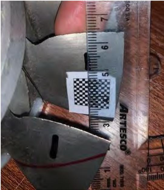
*Figura 42. Medición de la Dimensión Real del Segundo Defecto Simulado.*
