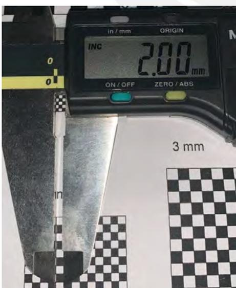
*Figura 43. Patrón de Calibración de 2 mm. Elaboración Propia*
