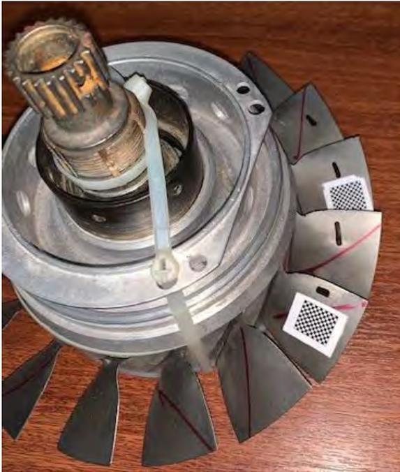
*Figura 38.* Procedimiento de Calibración para Medición en las Veletas del Compresor. Elaboración propia.
