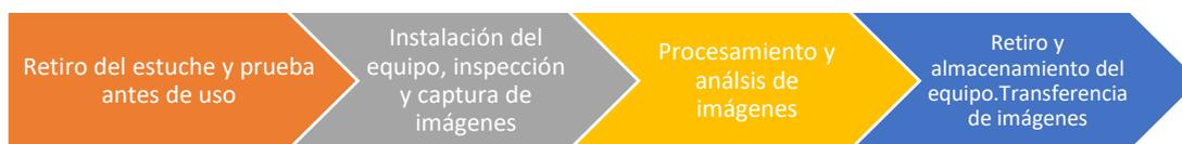
*Figura 26.* Funcionamiento en etapas de la operación del equipo boroscópico.
