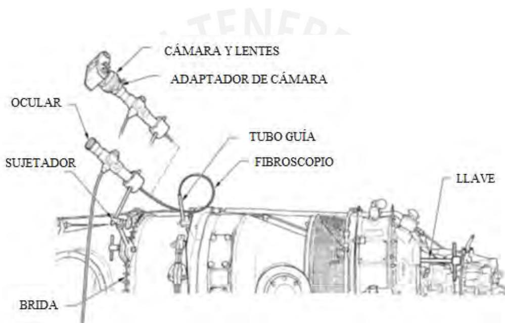
*Figura 21.* Guía de Instalación Para Inspección Boroscópica en un Motor PT6A. Adaptado de (Pratt & Whitney, 2019)
