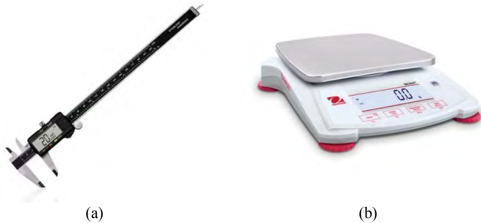
Figura 3.4. Equipos para la medición de la densidad: (a) Vernier (Pie de rey) y (b) balanza Ohaus.
