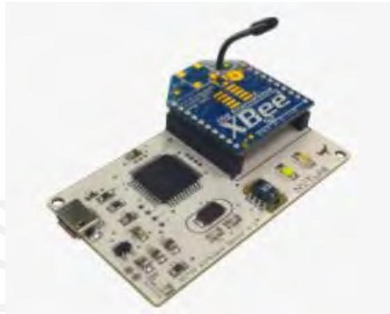
Figura 3.5. Nodo NITOS XBee [9]
