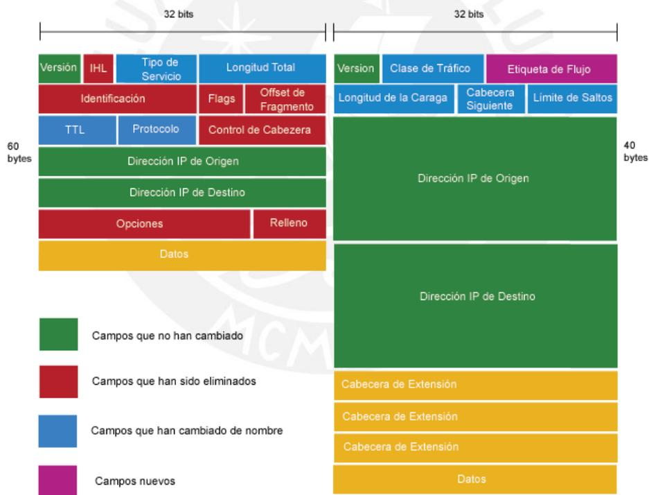
Figura 2.5. Comparación de los encabezados IPv4 e IPv6 [8]
