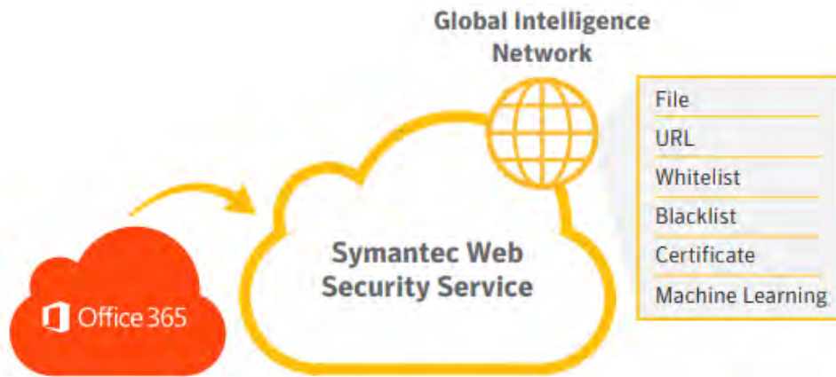
Figura 4- 7: Integración entre Web Security Service de Broadcom y Office 365. [71]
