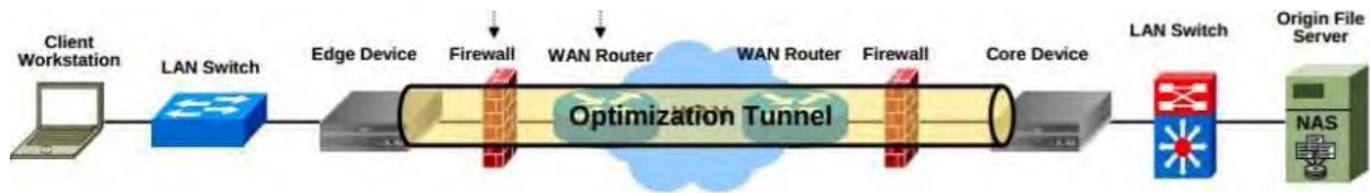
Figura 3- 5: Túnel de optimización entre aceleradores WAN.
