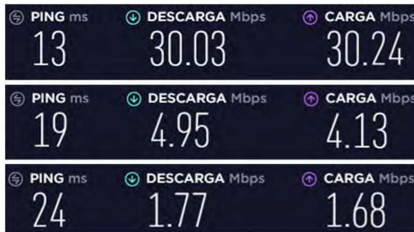
Figura 5- 22: Resultados de pruebas de traffic shaping a 30, 5 y 2 Mbps aproximadamente.
